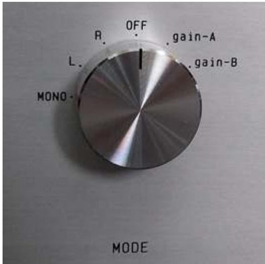
モードスイッチを切り替えることで、音声を片チャンネルのみにしたり、ステレオ音声をミックスしてモノラル音声に切り替える事が出来ます。切り替える事で、オーディオ全体のバランスの確認などが出来ます。
