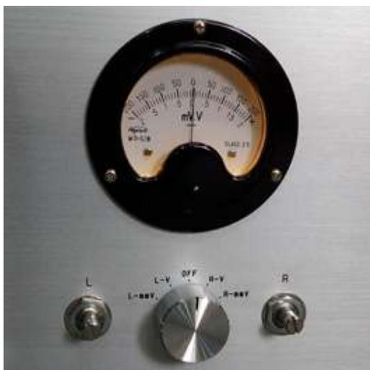
このVメーターは真空管 6SN7 の上下のゼロバランスを測るものです。バランスが大きく崩れると真空管を交換する必要があります。セレクターを TEST に切り替えて、ボリュームを半分（12時）まで上げて下さい。Rチャンネルの調整は、中央のツマミを R-V に切り替えます。メーターが大きく振れた場合は、真空管に異常があります。6SN7 を交換して下さい。小さく振れた場合は、R-mV に切り替えて下さい。右側の R ツマミを回し、メーターの振れを±50mV 以内に調整して下さい。
